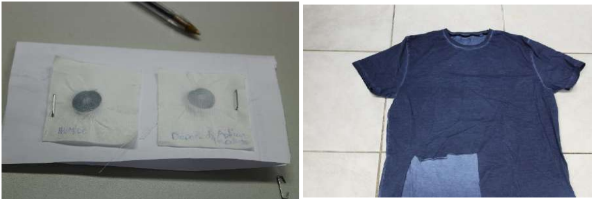
Figura 61: Tingimento vegetal e respetivos resultados de solidez à fricção depois da utilização de 40 ml/L de Fixamin PUK
