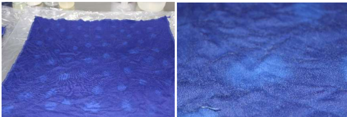
Figura 29: Acabamento aguarela realizado com água
