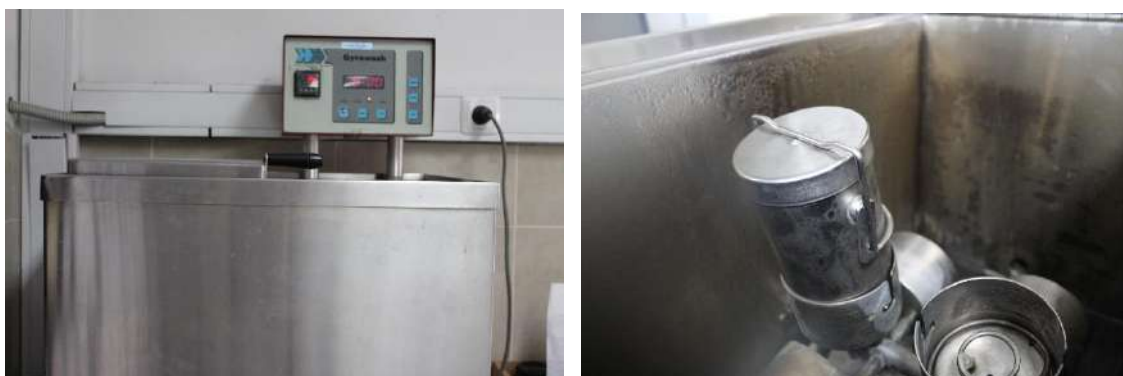
Figura 35: Gyrowash para a realização de ensaios de solidez à lavagem
