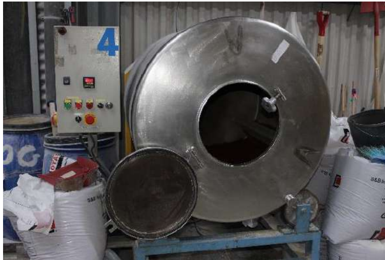
Figura 27: Máquina utilizada na realização do fade out
