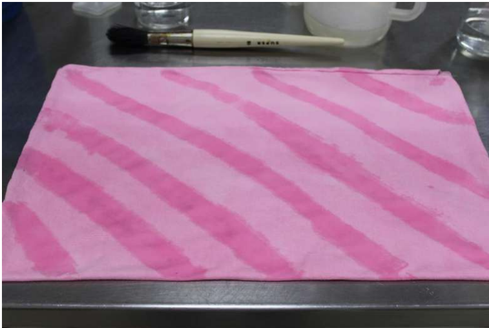
Figura 26: Exemplo de aplicação, através de pincelado, da resina Nofelding RE
