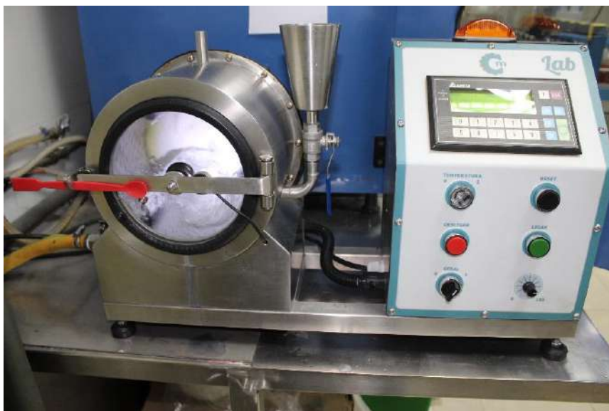
Figura 28: Máquina de laboratório utilizada para tingir e aplicar a resina nos testes do processo old dye
