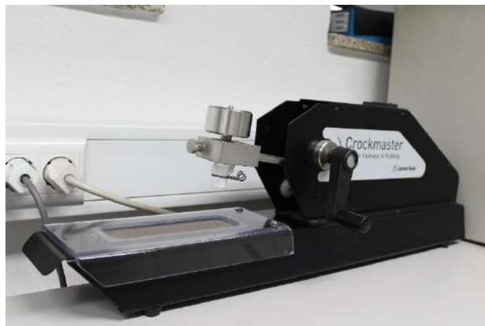
Figura 36: Crockmeter para a realização de ensaios de solidez à fricção
