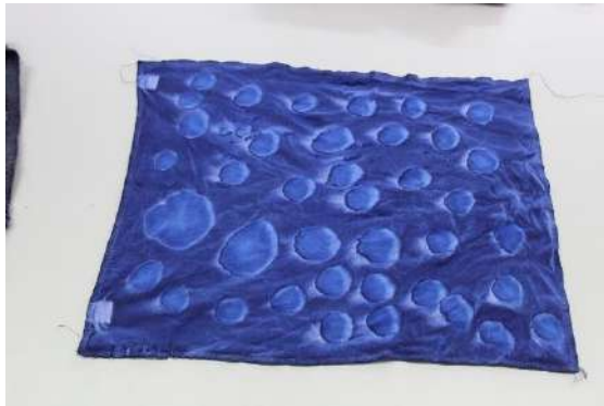
Figura 55: Resultado do acabamento aguarela realizado apenas com Eletrorep
