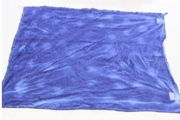
Figura 51: Resultado do acabamento aguarela realizado apenas com água
