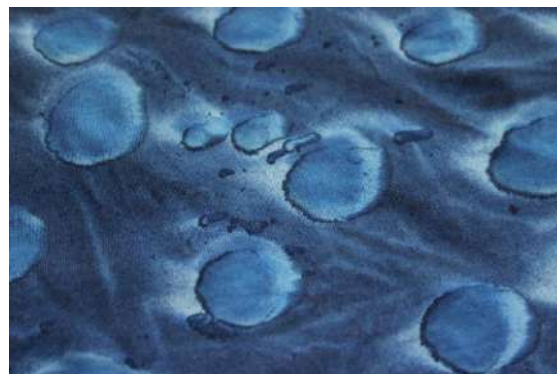
Figura 55: Resultado do acabamento aguarela realizado apenas com Eletrorep
