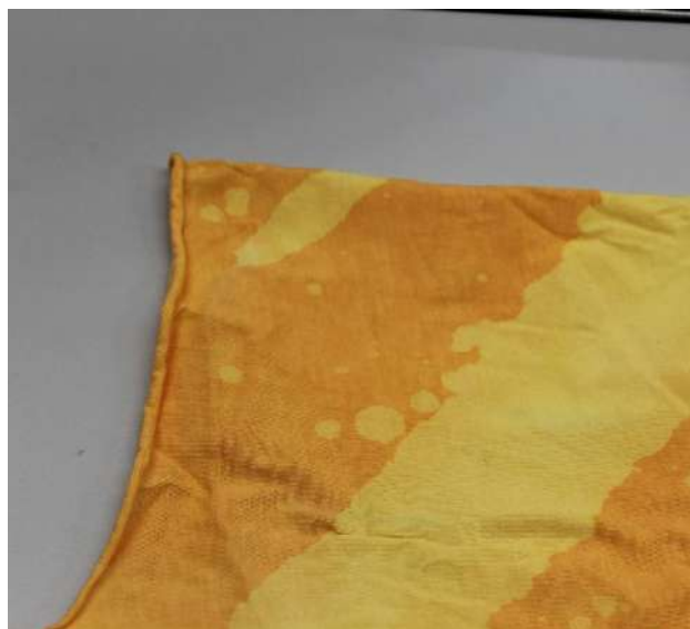
Figura 50: Resultado do teste com uma menor diferença de concentrações de corantes e 30 g/L de Nofelding RE
