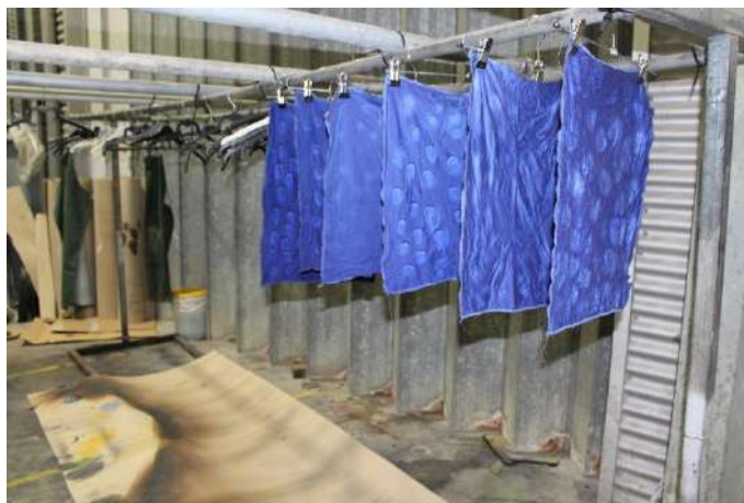
Figura 34: Método de secagem ao ar ambiente para o processo aguarela
