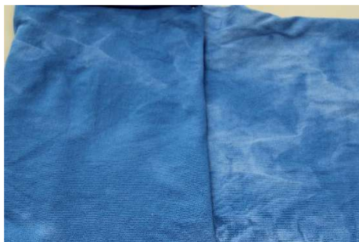
Figura 44: Contraste obtido na peça para uma concentração de 15 g/L de Nofelding RE
